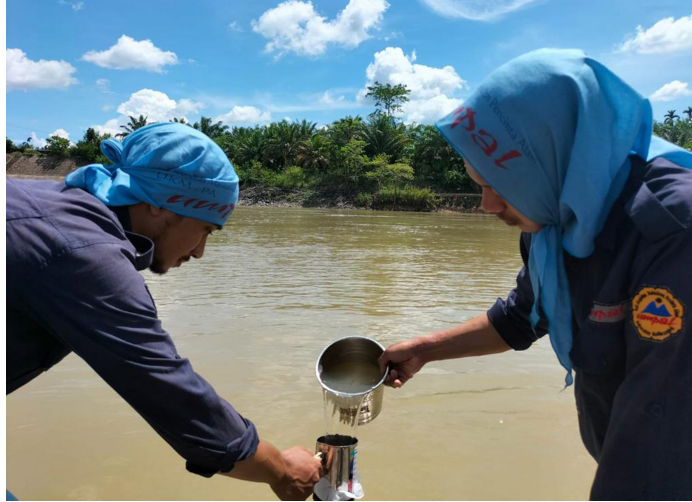
Dua peneliti dari Ekspedisi Jambo Aye mengambil sampel untuk menguji kualitas air di Krueng Jambo Aye yang terkontaminasi mikroplastik. Foto: Ist.
